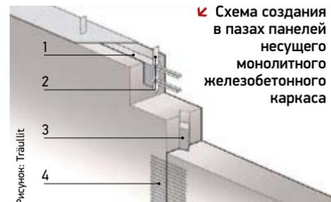
↙ Схема создания в пазах панелей несущего монолитного железобетонного каркаса
